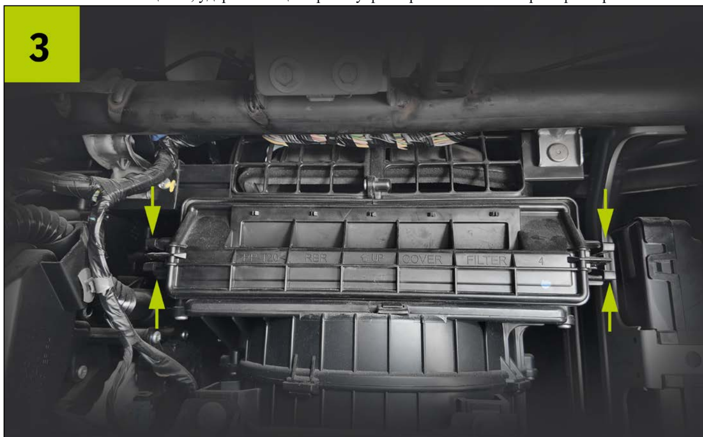
3. Отстегиваем защелки крышки корпуса фильтра.
