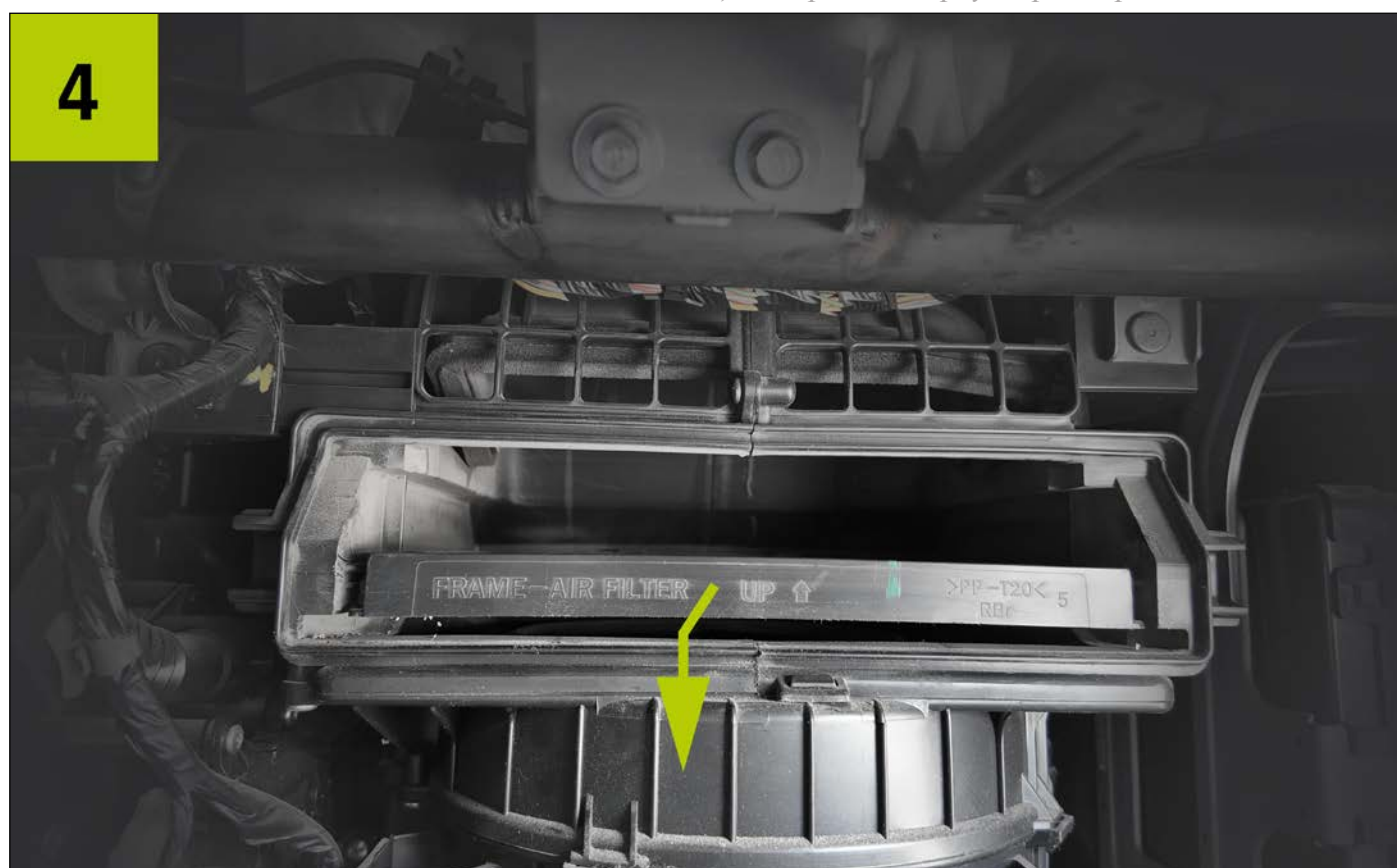
4. Извлекаем салонный фильтр из корпуса.
