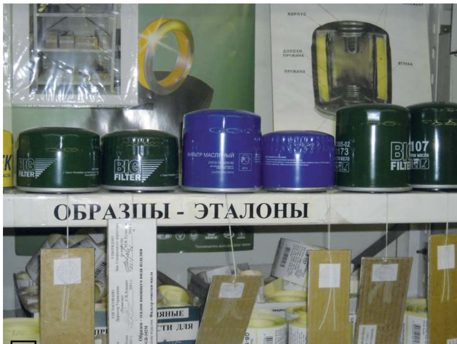
□ Для того, чтобы избежать возможности ошибок при сборке фильтров, в цехах установлены стенды с эталонными образцами
