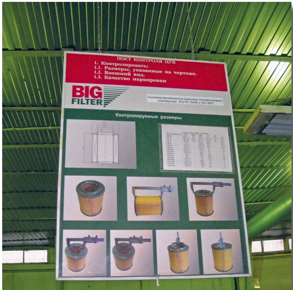
Контроль в компании возведен «в абсолют» — на каждом участке существуют посты, на которых висят стенды с наглядным изображением деталей и методом их проверки
