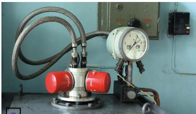
Испытание фильтра на пульсацию давления масла. За две секунды давление возрастает от нуля до 10 кгс/см<sup>2</sup> и тут же падает до нуля. Число таких циклов — 25 000
