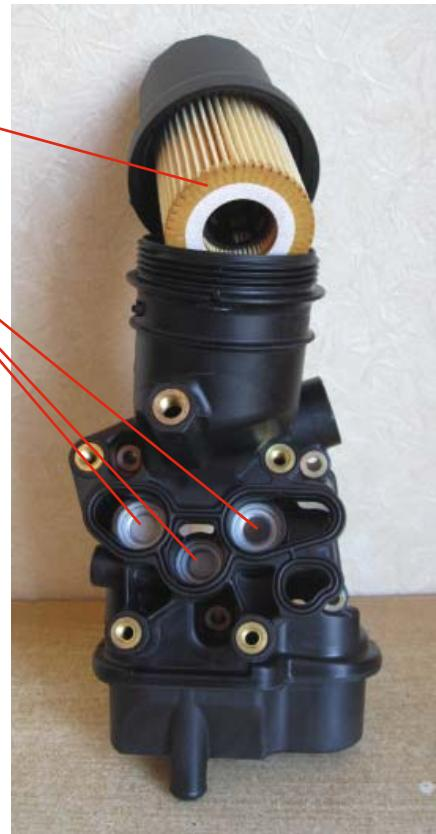
Масляный модуль компании MANN+HUMMEL со встроенными клапанами и заменяемым фильтроэлементом для Volkswagen и Audi. В настоящее время в Европе более 70% автомобилей производятся с такими модулями и MANN+HUMMEL — один из лидеров в их производстве
